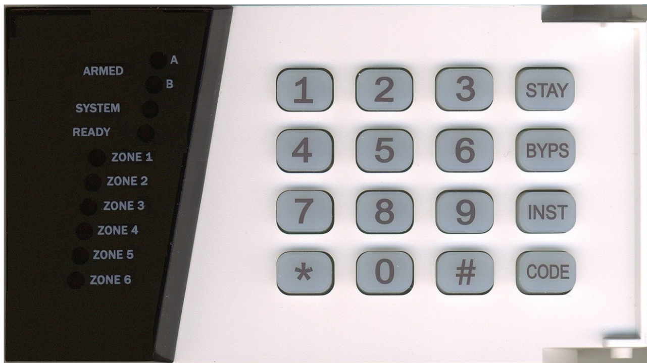
Drátová klávesnice SEL-SK pro 6 podsystémů - otevřená
